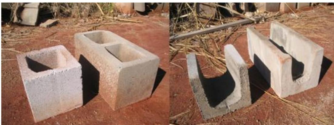
Figura 89 – Blocos de concreto utilizados na obra. Respectivamente, bloco comum e canaleta.
